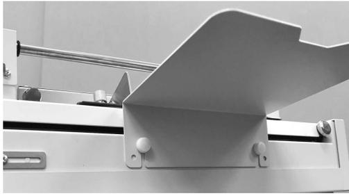
給紙サポート板のスリットを固定ネジ(2ヶ所)に引っかけ、固定ネジをしっかりと締めてください。
