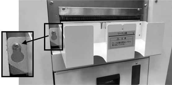
排紙トレイのダルマ穴を本体の固定ねじに差し込み、取り付けます。
