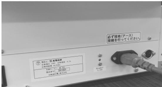
付属の電源コードを製品の差し込み口に挿入します。
