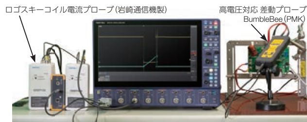
GaNデバイス評価基板のスイッチング電圧・電流 測定例
