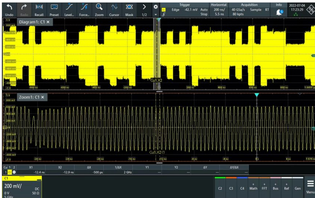
図 16 : AWG-5000 シリーズで RF モードを使用して生成された IF 信号 |DSO Rohde&Schwarz RTP164
