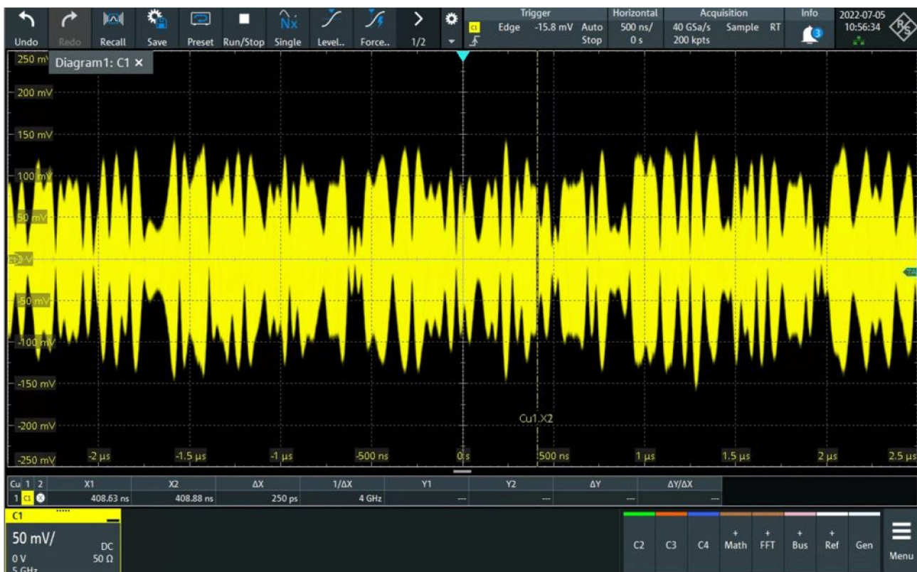
図 25 : AWG-5000 を使用した 4GHz キャリアの RF 信号 |DSO Rohde&Schwarz RTP164
