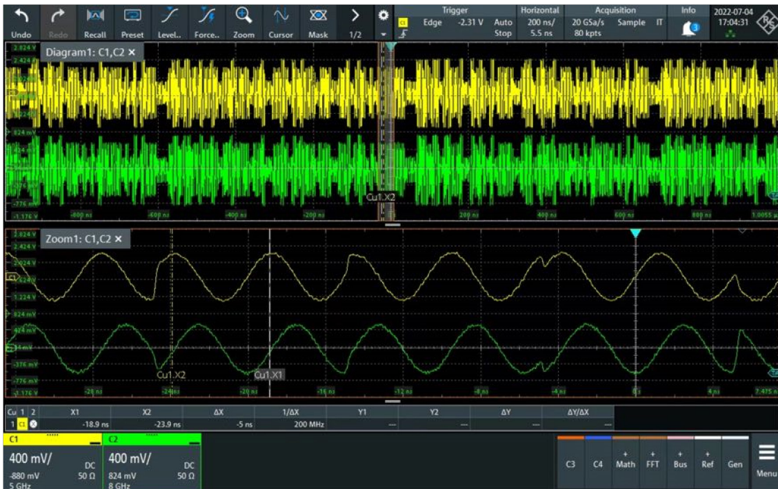
図 12 : 16QAM IF 信号 – オシロスコープ Rohde&Schwarz RTP164 -
