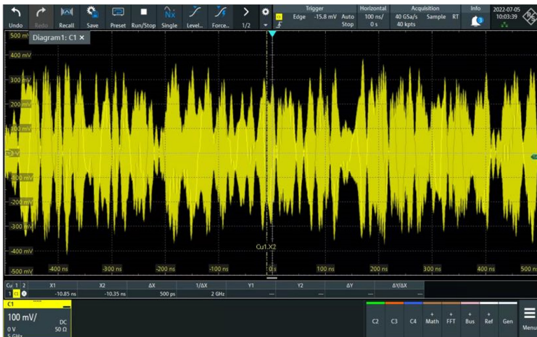
図 22：AWG-5000 シリーズの RF モードで生成された RF 信号 | DSO Rohde&Schwarz RTP164
