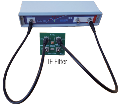
構成例(Bode 100) 治具基板
