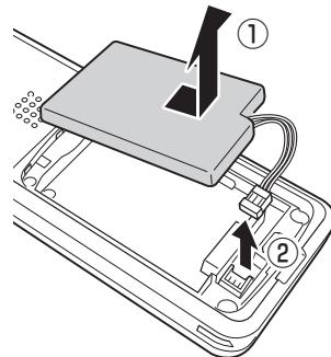
**3 電池パックを取り外した後 (1)、コネクタを外します (2)。**
