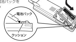
図のように、電池パックのケーブルを整形してください。
