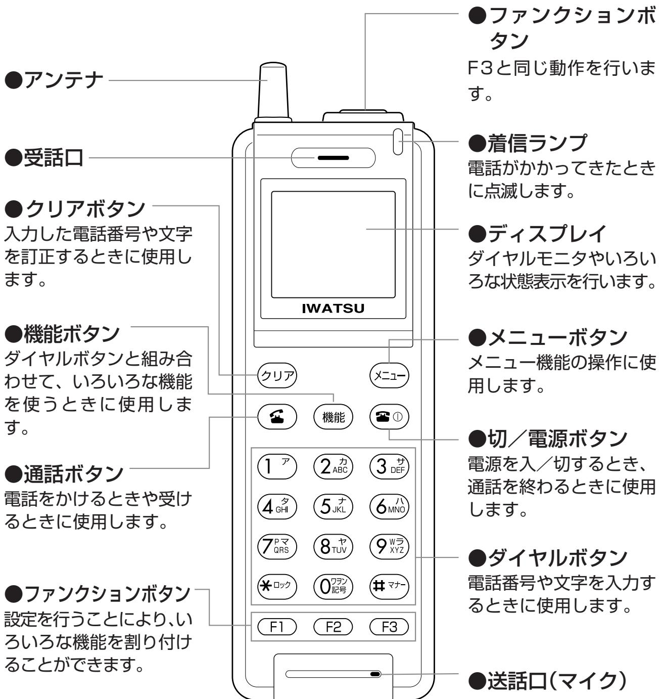
※ダイヤルボタン(5<sub>JKL</sub>)の部分に突起が付いていますが、この突起は目の不自由な方の操作を容易にするためのものです。
