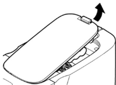
**2** 電池コネクタを引き抜いて、電池パックを取り出します。
