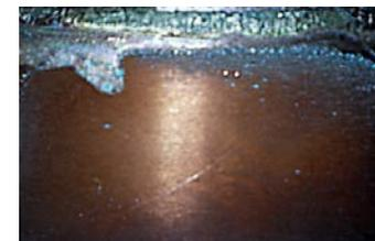
硫化ガスは自然界・排ガス中に存在し、段ボールからも微量に放出されます(製造時の残留ガスによる)。本製品は他の金属より硫化水素による腐食が激しい、銀・銅金属を含む製品に対して、腐食を軽減・遅らせる効果が実証されました。
