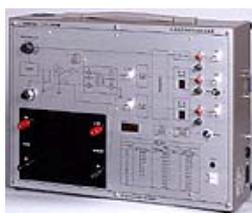
ITF-208は、波形記憶装置法（高速デジタイザ方式）を用いた交流磁気特性測定法の原理、試料の材質の相違によるB-Hカーブの特徴など特性値の理解、周波数特性グラフの作成などの応用測定の実習ができる実習装置です。
