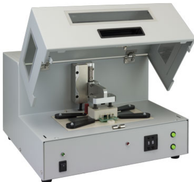
小型単板磁気測定装置 SY-956外観 (商品紹介ページは こちら )
