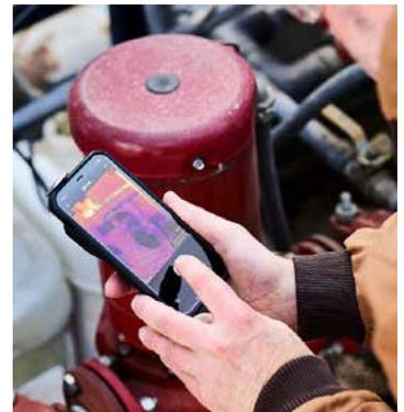
FLIR ONE Edge Proは、スマートフォン／タブレットとワイヤレス接続することで手の届かない場所にある対象物を容易に検査できるだけでなく、スマートフォン／タブレットにフックして片手で簡単に操作することもできる、革新的なサーモグラフィカメラです。VividIRとFLIR MSX（スーパーファインコントラスト機能）を組み合わせることで、自然な操作であらゆる位置や角度から鮮明な赤外線画像を撮影できます。クラウドサービスのFLIR Igniteを使用することで、FLIR ONE Edge Proで撮影した画像や動画を瞬時にクラウドにアップロードし、データを編集、整理、保存、共有できます。また、FLIR ONE Edge Proは、これ1台でiOSおよびAndroid OSのどちらにも互換性があり、スマートフォン／タブレットのOS、端子、サイズ、将来のアップグレードに柔軟に適合します。
