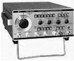
FG-330は、0.01Hz～1MHzの周波数帯域で、正弦波、三角波、方形波（対称、非対称）、直流の各出力波形を備え、VCFが可能な信号発生器です。低価格・簡易タイプで手軽にご使用いただけます。
