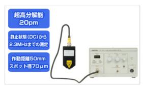
ST-3761に採用した光へテロダイン方式は、わずかに周波数の異なる信号光と、参照光のレーザ光を重ね合わせて干渉させ、そのビート(うなり)信号を検出する測定手法です。
