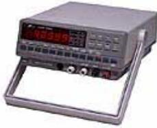
VOAC7413は、岩通独自の3重積分方式A/Dコンバータを採用。専用LSIと高速8ビットCPUによりフルスケール40999カウント、最高サンプル・レート毎秒100回を実現しました。
