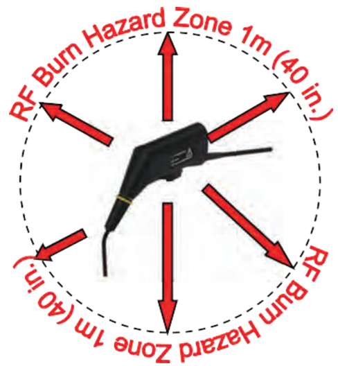
プローブヘッドとチップケーブル周辺の RFバーンハザードゾーン
