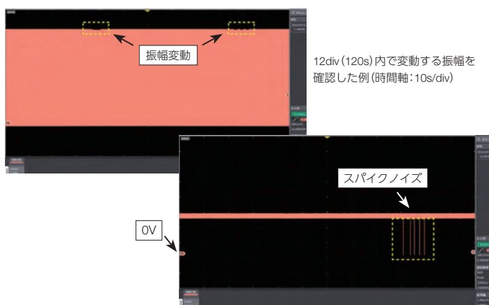
スパイクノイズをピーク検出機能で検出した例(時間軸:1s/div)
