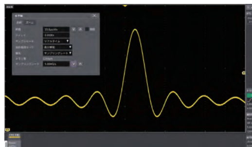
高分解能モードでノイズを低減した波形
