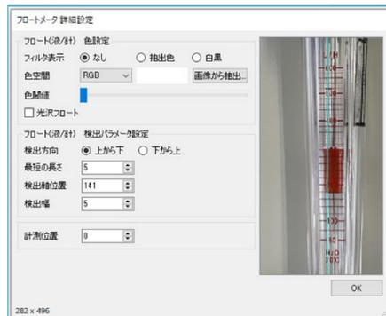
フロートや液面の色を指定して、フロートメーターの読み取り方式を調整します。
