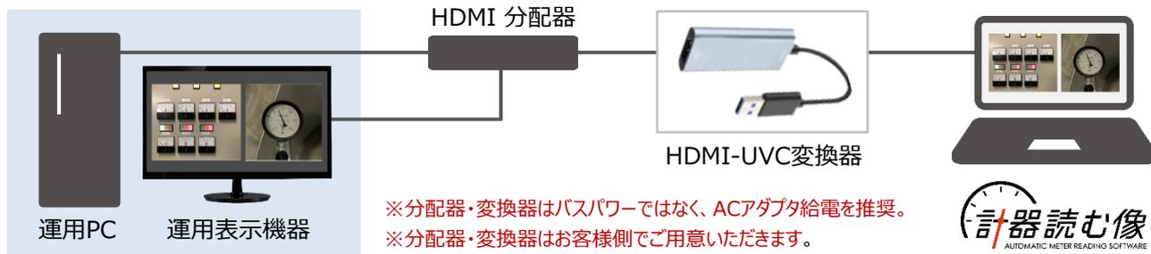
USB接続のHDMI-UVC変換器からの映像は、計器読む像ではUSBカメラと同じ扱いになります。そのため、変換器からの映像で初期設定を行うことにより、計器読む像での読み取りが可能になります。
