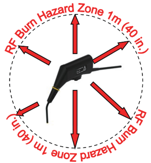
プローブヘッドとチップケーブル周辺の RF バーンハザードゾーン
