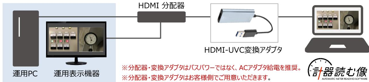
USB接続のHDMI-UVC変換アダプタからの映像は、計器読む像ではUSBカメラと同じ扱いになります。変換アダプタからの映像で初期設定を行うことにより、計器読む像での読み取りが可能になります。
