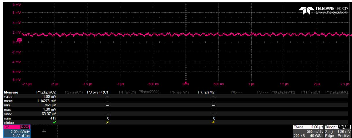
**重要:** 信号が「小さすぎる」場合、オシロスコープのバックグラウンドノイズが信号振幅に匹敵することに注意してください。
