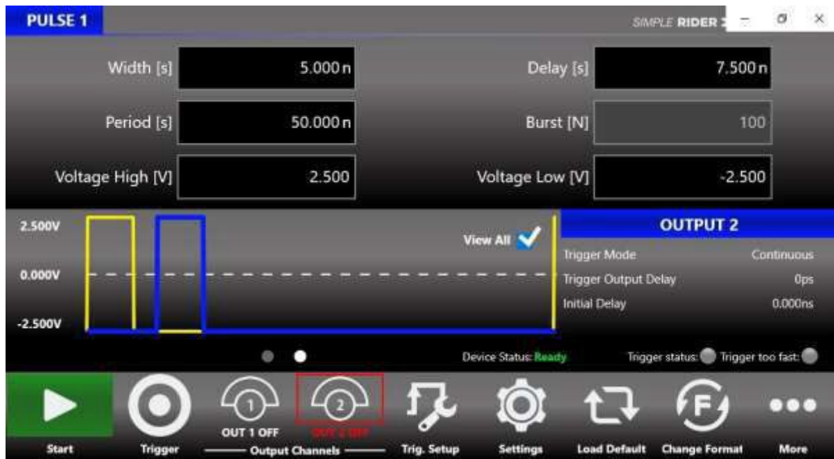
図 2： SimpleRider UI、（前パルスから）7.5ns 遅延した 2 つの狭パルス（5ns）の生成、
