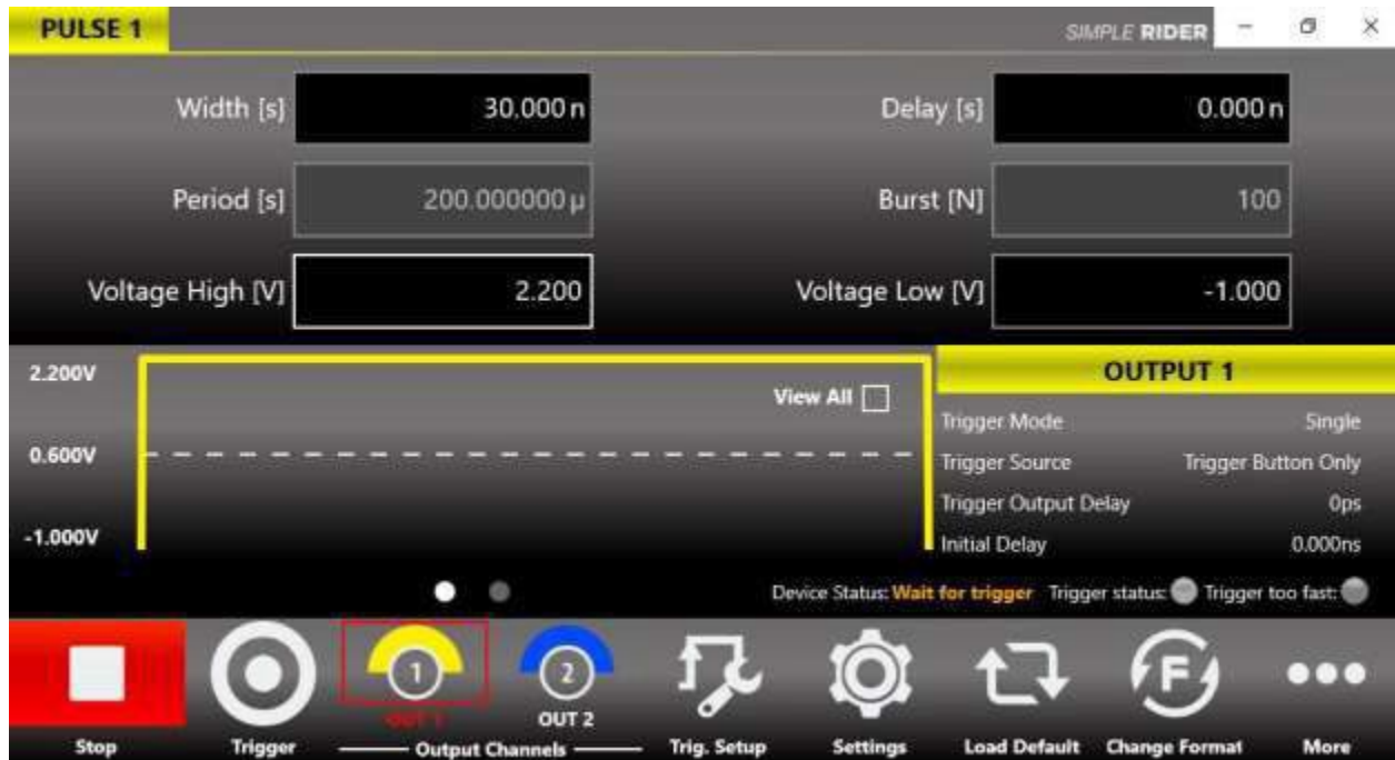
図 9：ショートパルスの UI、ベースライン-1V、最大 2.2V（振幅 3.2V）、長さ 30 ns シングルモード
