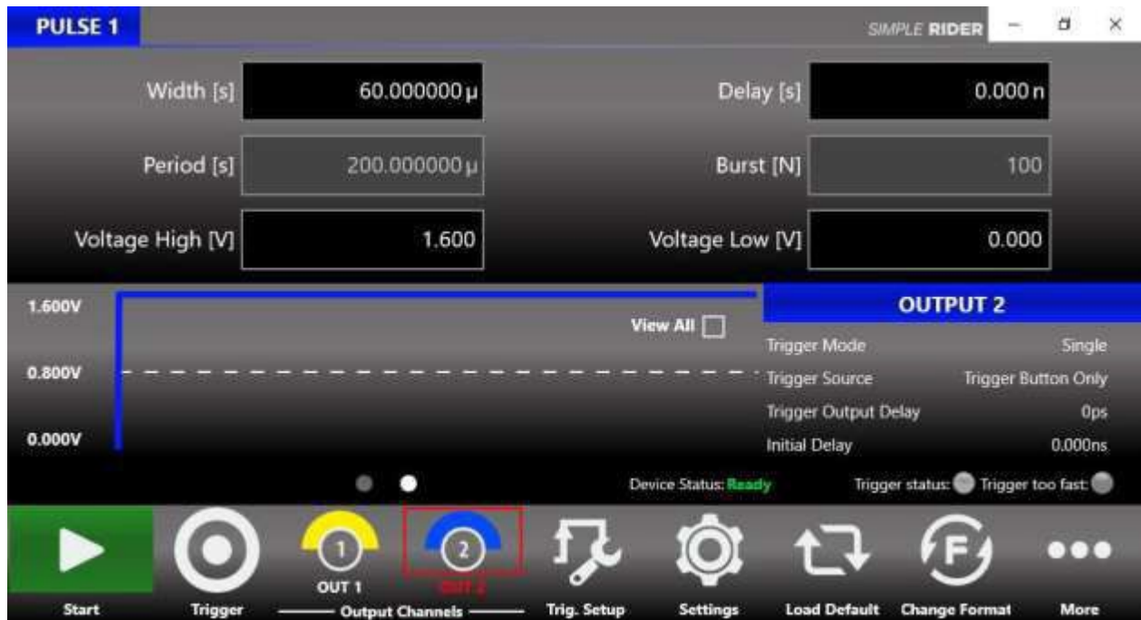
図 11：スローパルスの UI、ベースライン 0V、最大 1.6V（振幅 1.6V）、長さ 60 \mu s シングルモード
