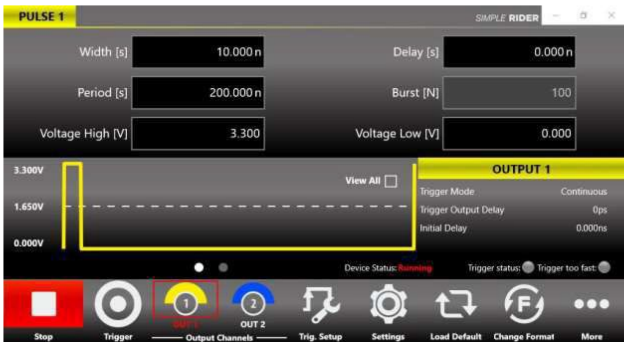
図 4 : SimpleRider PG、極小パルス 10ns@3.3V (リセットパルス) の設定
