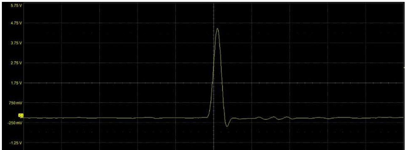
図 8：振幅 5Vpp、パルス幅 100ps
