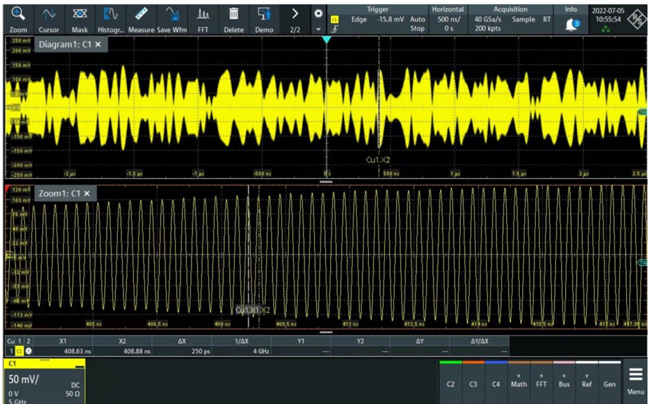
図 26 : 4GHz キャリアの RF 信号 - ズームイン -
