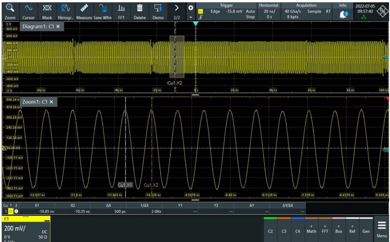
図 33 : AWG-5000 シリーズが RF モードで生成した 8PSK RF 信号 |DSO R&S RTP 164
