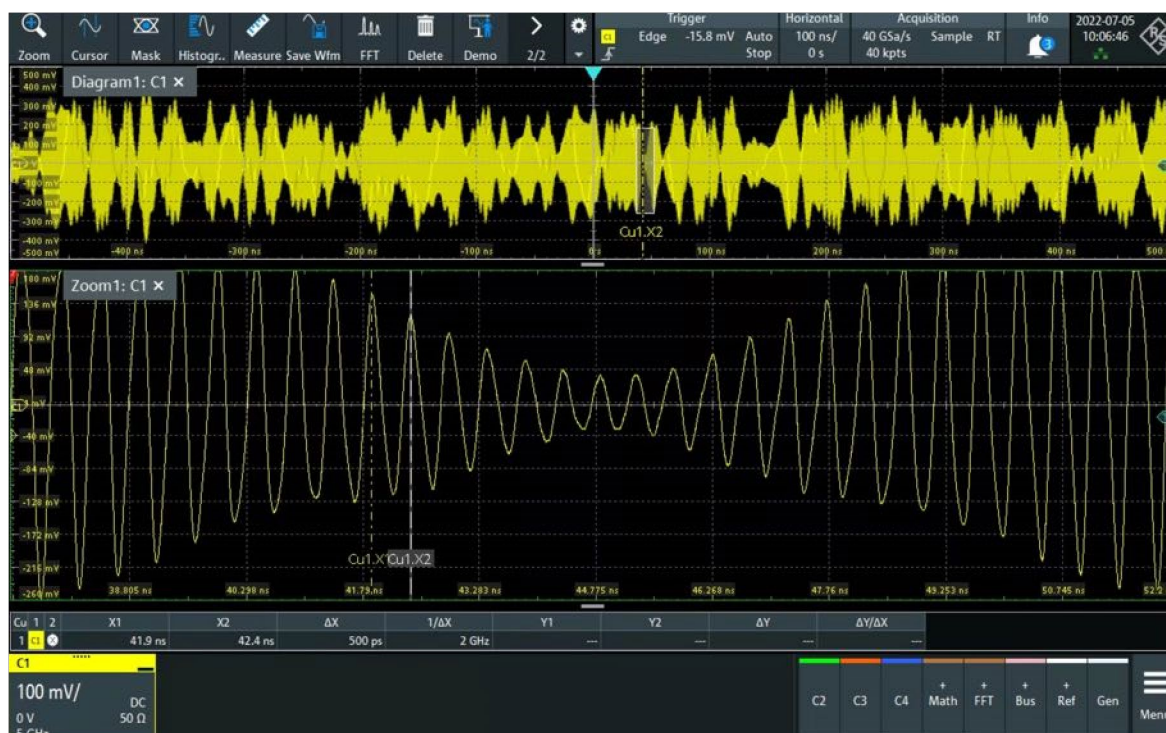
図 23：2GHz キャリアの RF 信号
