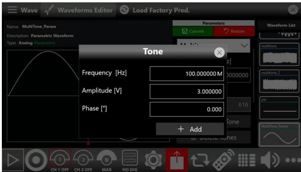
「Add New Tone」ボタンを押して3番目のトーンを追加し、周波数300MHz、振幅3Vppの正弦波を選択します。
