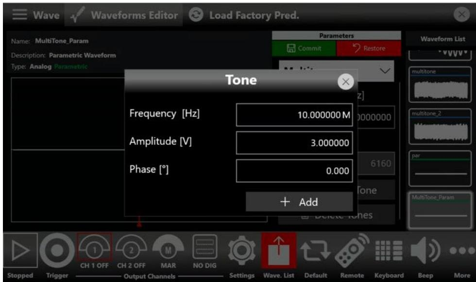
「Add New Tone」ボタンを押して2番目のトーンを追加し、周波数100MHz、振幅3Vppの正弦波を選択します。
