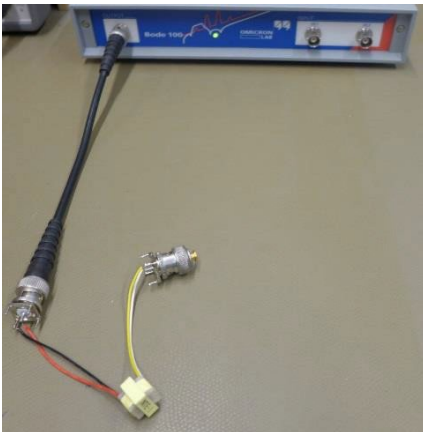
Figure 14: 測定セットアップ – 二次巻線短絡時
