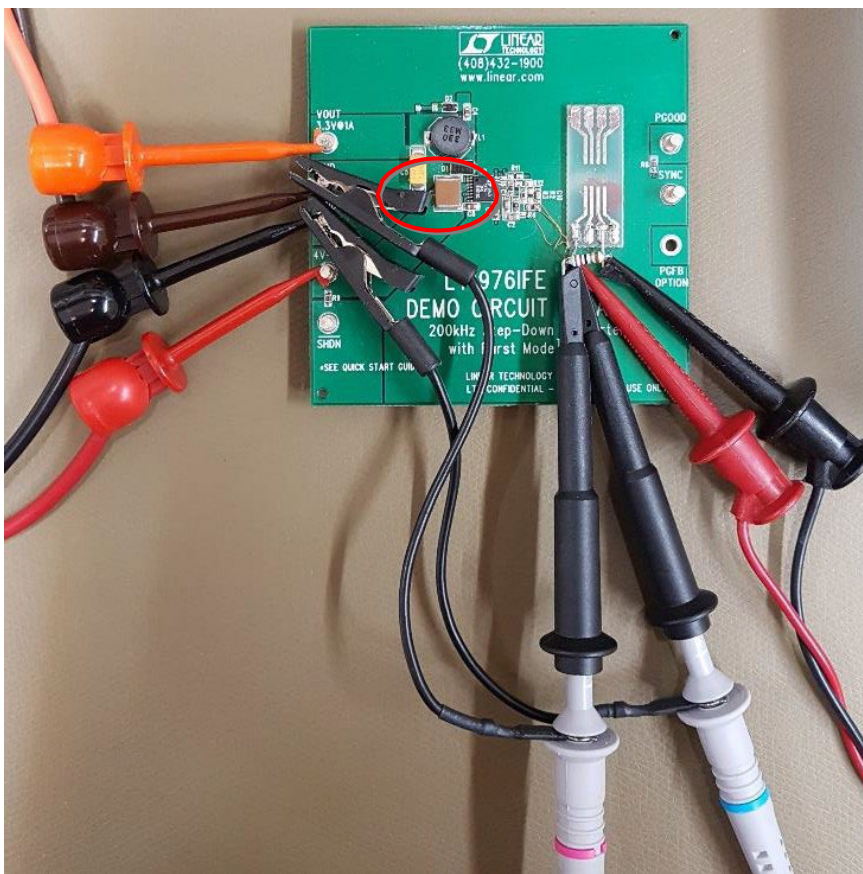
Figure 10: 両方のプローブを同一点に接続した状態
