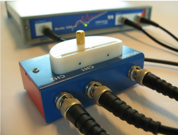
Figure 7: 負荷がない状態のインピーダンスアダプタ
