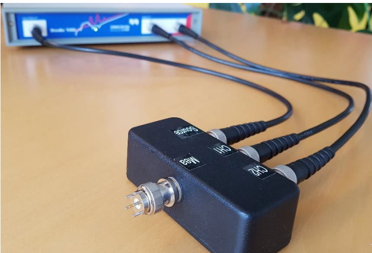
Figure 8: 何も接続していないBNC コネクタを接続した状態での Open 校正
