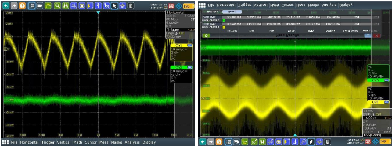
Figure 7: スwitchングリップル(左)と、100 Hz の攪乱信号である v_{out} と v_{FB} (右)
